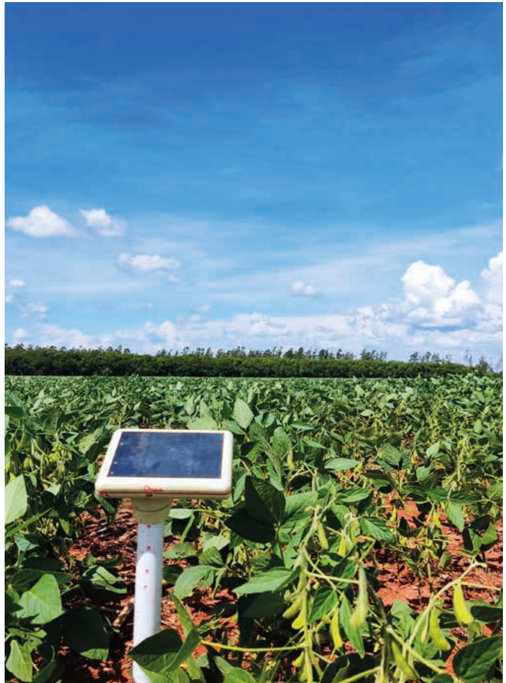
Figura 2. Sensor IoT utilizado para medición de humedad del suelo.
